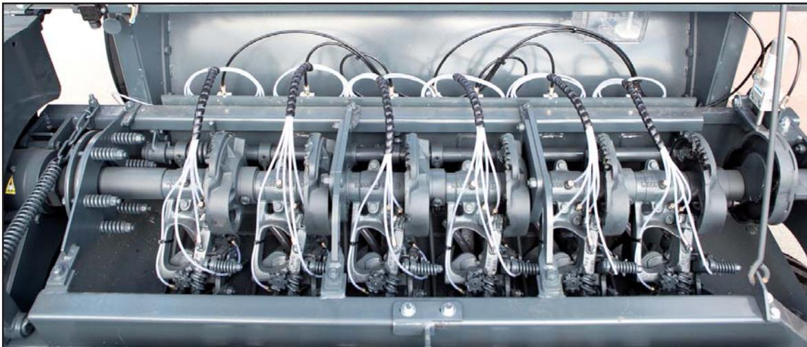
**ВЫСОКОЭФФЕКТИВНЫЙ МЕХАНИЗМ, ОБЕСПЕЧИВАЮЩИЙ ВСЕ ПРЕИМУЩЕСТВА УЗЛОВЯЗАНИЯ КАК С ДВОЙНЫМ (меньшие нагрузки на шпагат и узловязатели), ТАК И С ОДИНАРНЫМ УЗЛОМ (меньшие обороты с низким износом узловязателей).**
