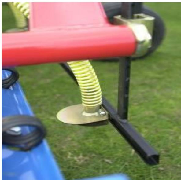
4. Твердая труба (диам. 25mm) крепится с помощью фиксаторов на секциях рамы болтами М8 в каждом крыле.
