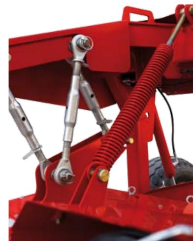
Компенсирющая пружина обеспечивает копирование рельефа
