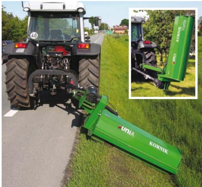
KORNİK Vario с гидравлической рукой в состоянии косить канавы, подрезания живых изгородей в вертикальном положении
