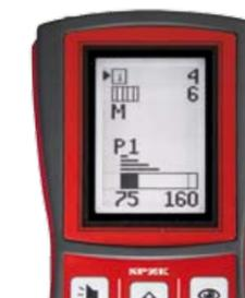
Контроль активных функций машины и диаметра рулона
