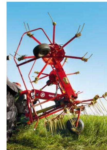
Транспортное положение – внешние рабочие колеса сворачиваются гидравлически
