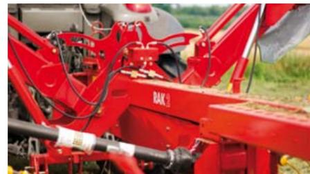
Механический замок – гарантирует легкое смещение роторов к положению доступа и безопасности во время транспортировки
