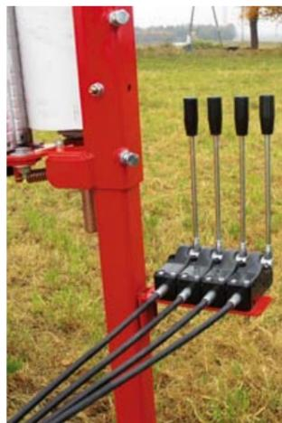
XLH – версия с механическим распределителем
