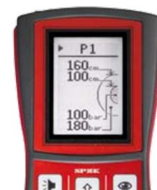
Программирование диаметра рулона и плотности (отличающейся для середины и внешнего слоя)
