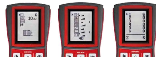
GUICIO XL E, FALA 2 XL Premium – контролирует режим работы обмотчика автоматический или ручной, устанавливает количество слоев обмотки, сигнализирует о разрыве пленки
