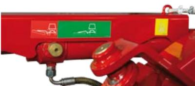
Указатель на бампере позволяет легко переводить косилку в транспортное положение
