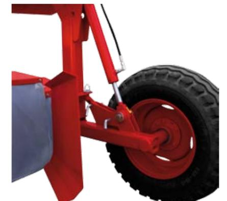
Регулировка высоты среза гидроцилиндром
