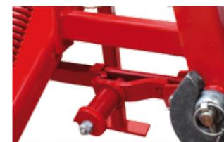
Защитный механизм – полиуретановый предохранитель, для защиты косилки от повреждений
